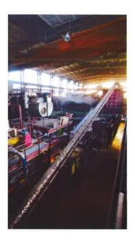
Der Pyrolyseprozess ist ein thermisches Verfahren, in dem die Zersetzung organischer Stoffe unter Luftabschluss bei höherer Temperatur erfolgt und der organische Anteil vollständig entgast wird.
